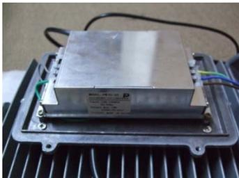
本体内のユニットタイプ内臓型電源は、箱型の防水用カバーで保護されています。
