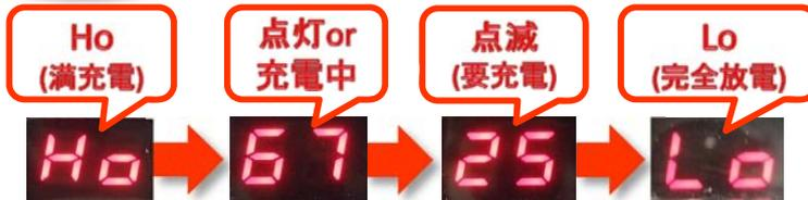
バッテリーBOX上部の表示窓に、バッテリーの残量が“%”で表示されます(100%=Ho表示、0%=Lo表示)。表示が25%以下になったら、早めに充電して下さい。
